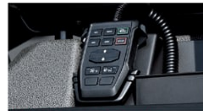
VASO(차량 에어서스펜션 컨트롤) 시스템. 차량의 주행 안전성과 승차감을 최적화하기 위해 에어서스펜션을 전자적으로 제어하는 시스템.
