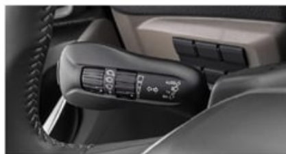
레인 센싱 자동식 와이핑 시스템 및 자동 작동 상황등.
